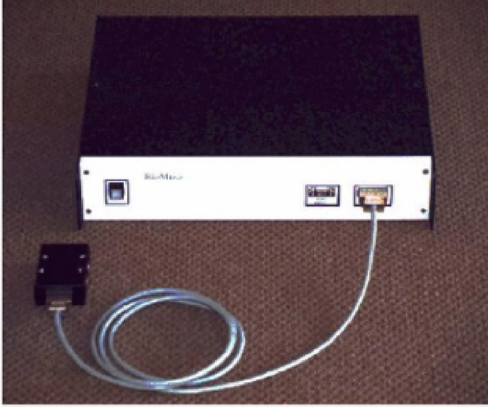
Şekil 23: Atau Tanaka “BioMuse” 8 kanallı nöral sinyalleri elektrik enerjisine çeviren controller (1992)
