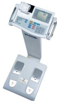
Şekil 3.2. TANITA BC-418 MA Biyoelektrik İmpedans Analiz cihazı (44)
