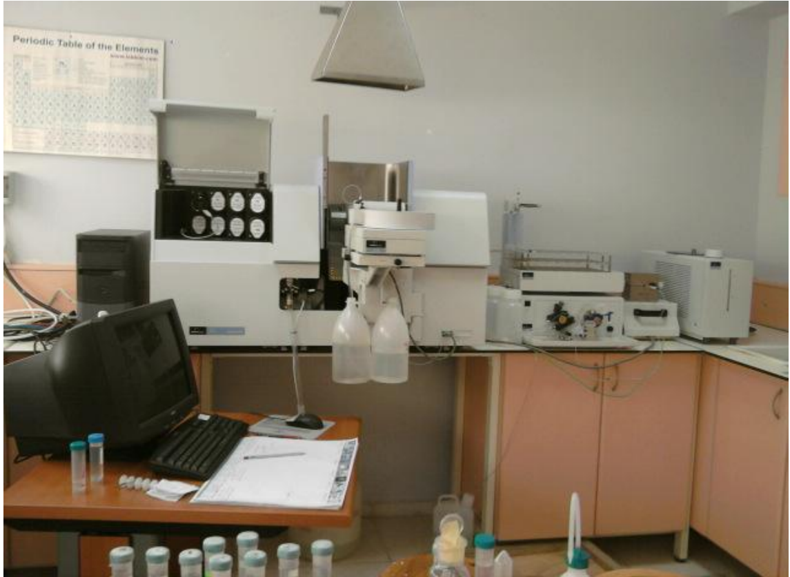
Resim 3.1: Perkin Elmer AAnalyst 800 Atomik Absorbsiyon Spektrometresi.
