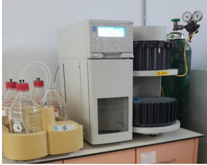
Şekil 3.8. ASE–200 Hızlandırılmış solvent ekstraktörü
