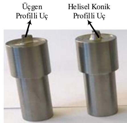
Şekil 2. SKK işleminde kullanılan farklı geometrilerdeki uçlar
