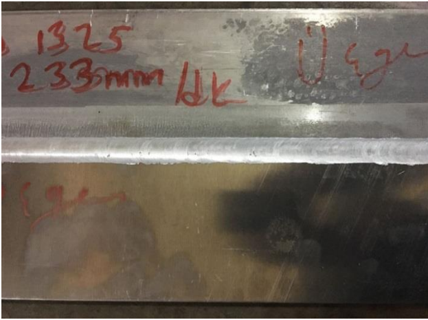
Şekil 3. Üçgen karıştırıcı uçla SKK yapılan bir plaka
