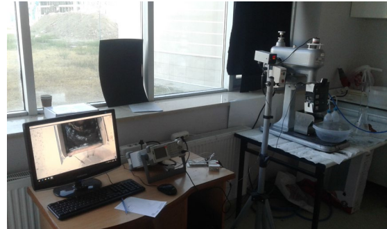
Şekil 1. Çalışmada kullanılan flotasyon makinesi ve kamera sistemi
