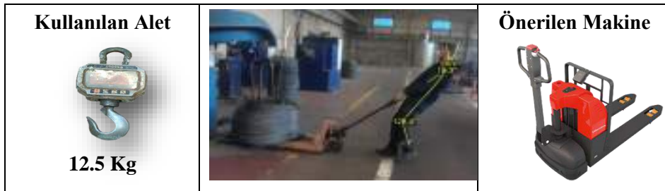
Şekil 15. Dolan Sepetin Transpaletle Kaldırılması İşlemi İyileştirme Önerisi
