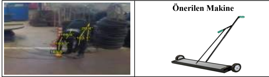
Şekil 14. Hurda Tellerinin Toplanması İşlemi İyileştirme Önerisi
