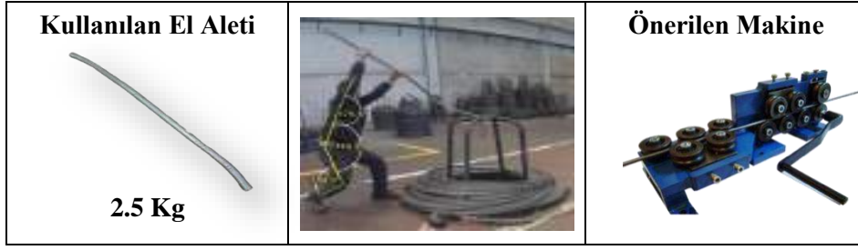
Şekil 13. Hadde Çapına Uygun Telin Doğrultma İşlemi İyileştirme Önerisi
