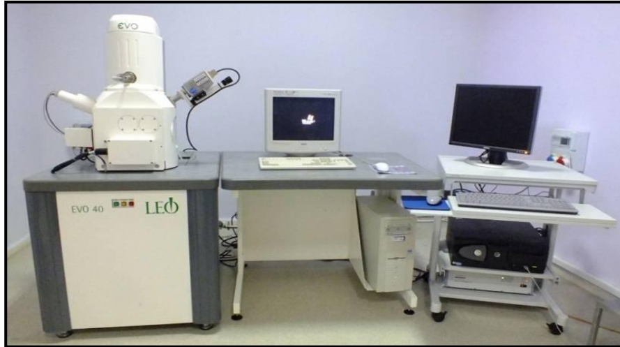
Şekil 3.9. Taramalı Elektron Mikroskobu (SEM) ve EDS ünitesi.
