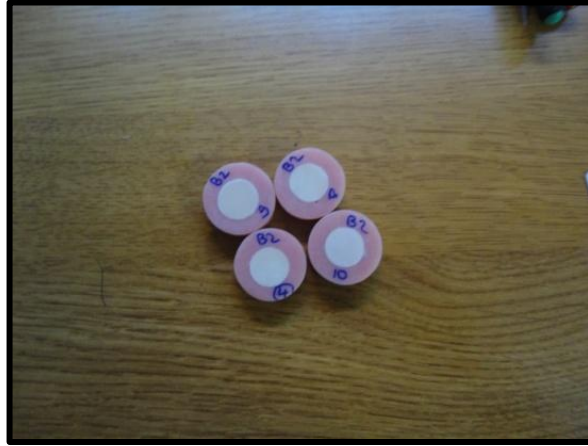
Şekil 3.6. Örneklerin akrilik kalıplar içine gömülmüş hali
