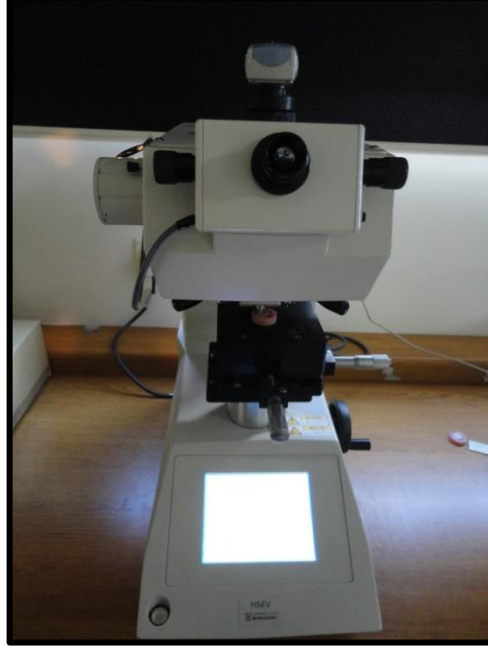
Şekil 3.8. Vickers micro sertlik cihazı ve örnek konumlandırılması
