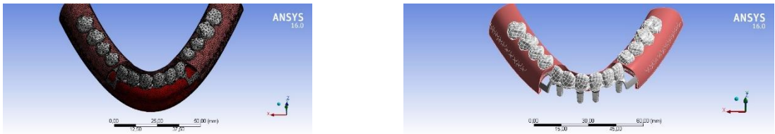
Şekil 3.20. 4 implant – anterior sabit implant destekli proteze bağlanan RPI kroşeli distal uzantılı mandibular hareketli bölümlü protez.
