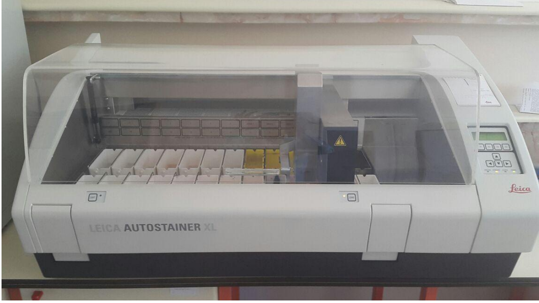
Şekil 3.21. Histolojik değerlendirme için kullanılan boyama cihazı
