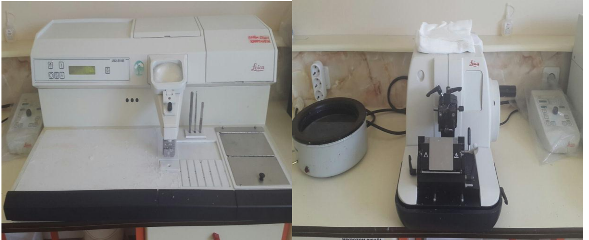
Şekil 3.20. Histolojik incelemeye hazır hale getirmek için kullanılan parafin blok cihazı ve mikrotom cihazı
