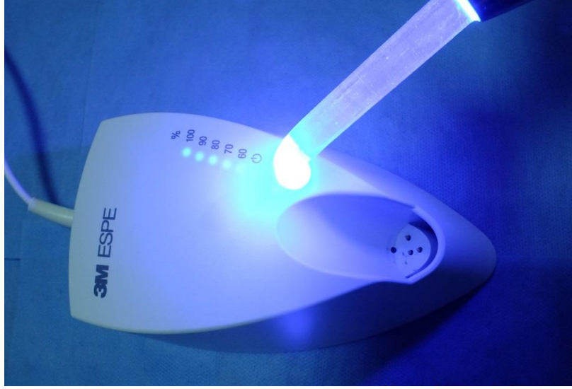
Şekil 3. 15: Polimerizasyon öncesi LED cihazının ışık yoğunluğunun ölçümü
