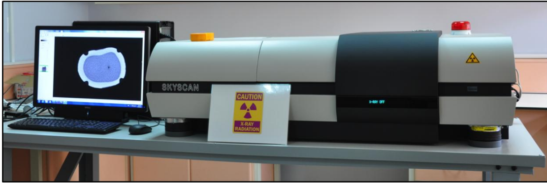
Şekil 3.10. Deneyde taramalar için kullanılan Skyscan 1172 Mikro-BT sistemi
