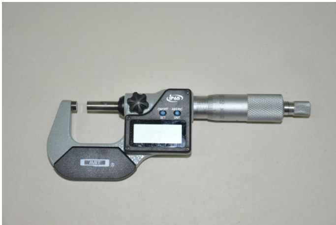
Şekil 3.2. Dışçap mikrometresi. (Mitituyo, Tokyo, Japan)
