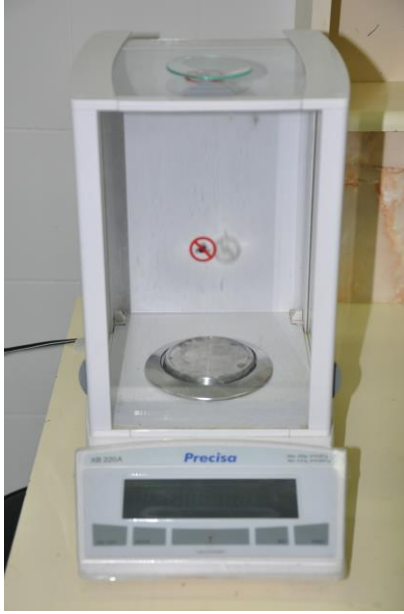
Şekil 3.1. Ratların kilolarının ölçüldüğü tartı aleti. (Precisa XB 220 A, Dietikon, Switzerland)
