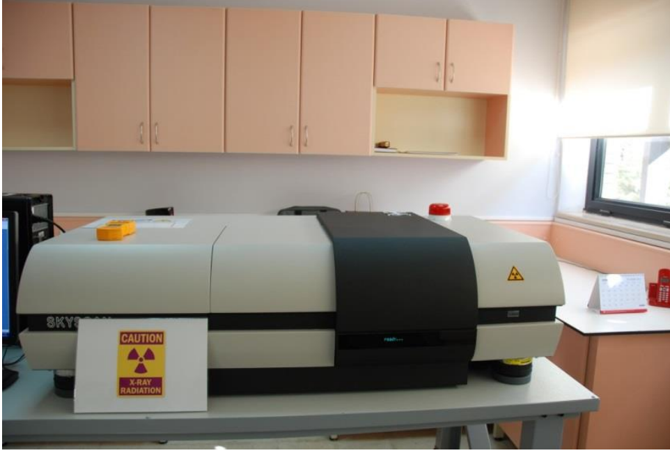
Şekil 3.18 Skyscan 1172 mikro-BT cihazı
