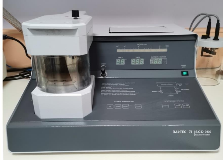
Şekil 3.15. Yüzey kaplama cihazı (Bal-tec SCD 050 sputter coater, Los Angeles, California, A.B.D.)
