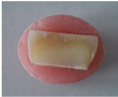
Şekil 3.4. Zımpara ile yüzeyleri düzeltilmiş numune
