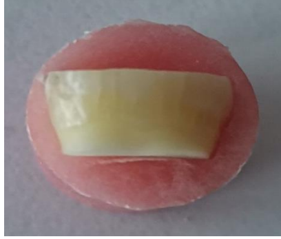
Şekil 3.3. Silindir bloklara gömülmüş numune
