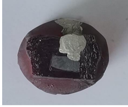
Şekil 3.16. Yüzeği altın-paladyum ile kaplanmış numune
