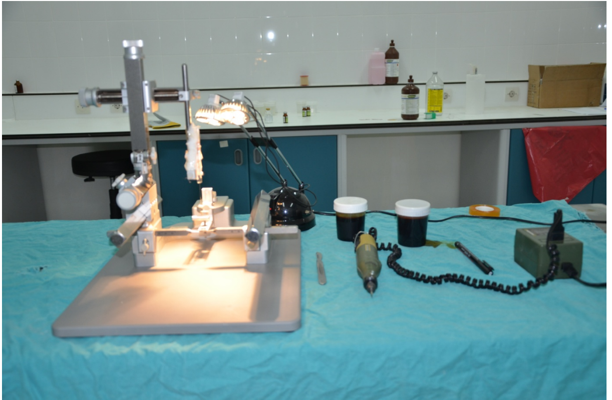
Şekil3.2. Denedeyde kullanılan stereotaksik alet, matkap ve soğuk ışık kaynağı.
