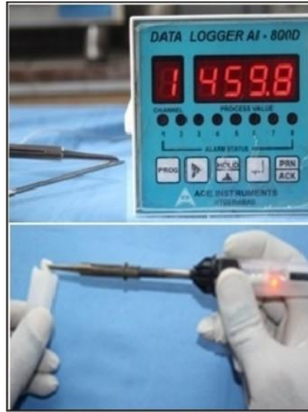
Şekil 2-6. Elektrotermal teknik ile debonding (134)
