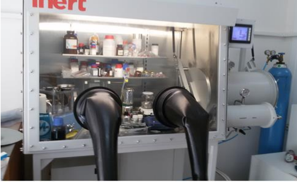
Şekil 3.5. Pil bileşenlerini bir araya getirirken kullanılan içerisinde argon gazı bulunan glove-box.
