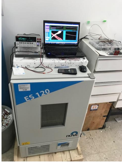
Şekil 3.8. Nuve ES120 model inkübatör ile Keithley 2401 ile kombine çalışan şarj deşarj ölçüm sistemi.
