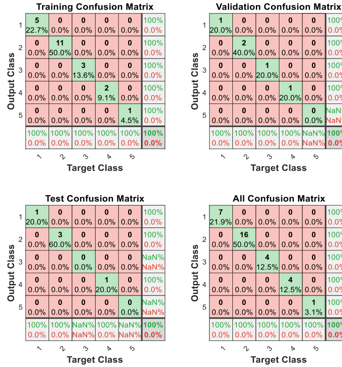
Şekil 4.24. Arıza sınıflandırması için MLP'nin doğruluk tablosu (1-Sağlıklı, 2-Kırık çubuk, 3-Statik Eksantriklik, 4-Dinamik Eksantriklik, 5-Stator arızası)
