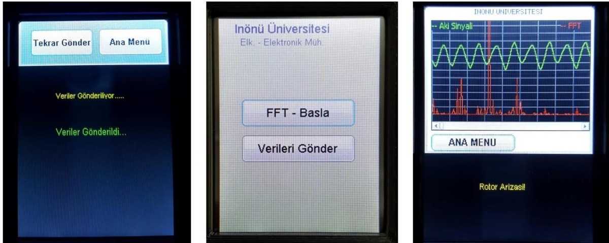
Şekil 6.4. TFT LCD panelde kaçak akı, FFT spektrum ve arıza gösterimi
