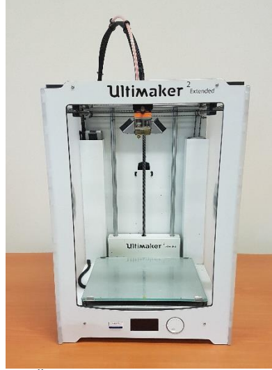
Şekil 1. Test Numunelerinin Üretiminde Kullanılan Ultimaker 2 Extended 3B Yazıcı
