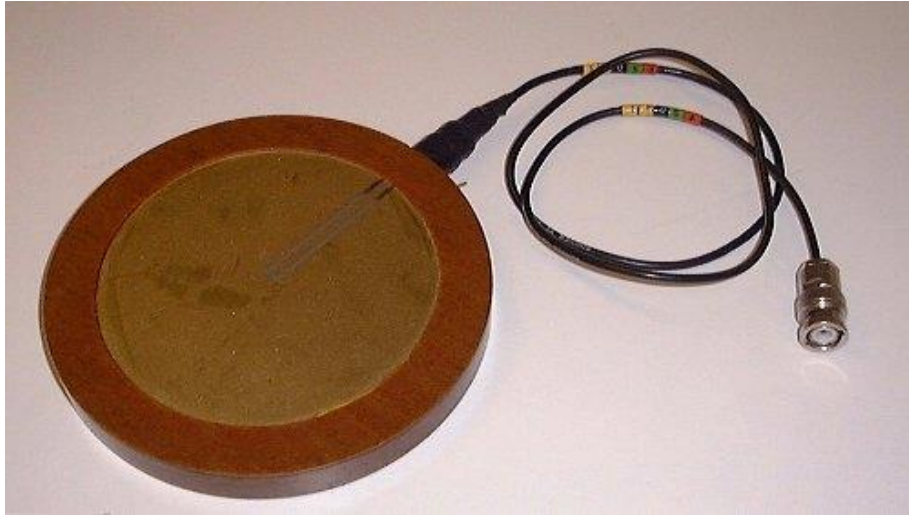
Şekil 5.14. Deney sisteminde kullanılan bilaminar zar tipi hidrofon
