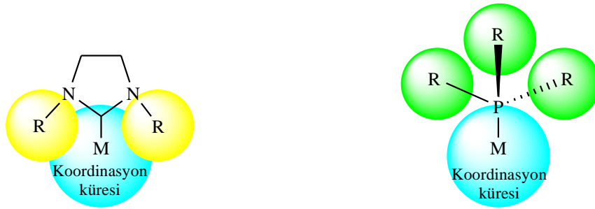
Şekil 1.3: NHC ve fosfin komplekslerinde ligantların metal üzerindeki sterik etkisi.
