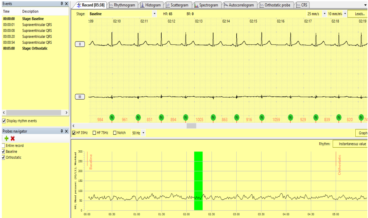
Şekil 3.9. Katılımcıların Poly-spectrum EKG cihazı ile çekilen 5 dakikalık kayıtlarının Neurosoft programındaki görüntüsü. Yeşil rengin kapsadığı alan EKG kayıtları II. ve III. Derivasyonlar için üst bölümde gösterilmektedir. Yeşil daireler içinde ise N-N'ler R-R aralıklarının normal olduğunu göstermektedir. Alt bölümde ise 5 dakikalık kayıt süresince kalp hızı değişkenliğindeki varyasyonlar gösterilmektedir.
