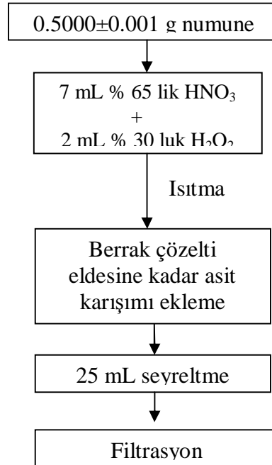
Şekil 3.1. Yaş yakma metodu ile çözünürleştirme yöntemi akış şeması
