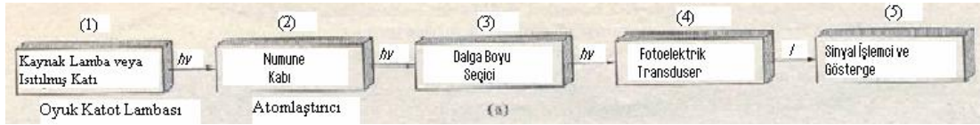
Şekil 2.6.2.: Atomik Absorpsiyon Spektroskopisinin Çalışma İlkesi
